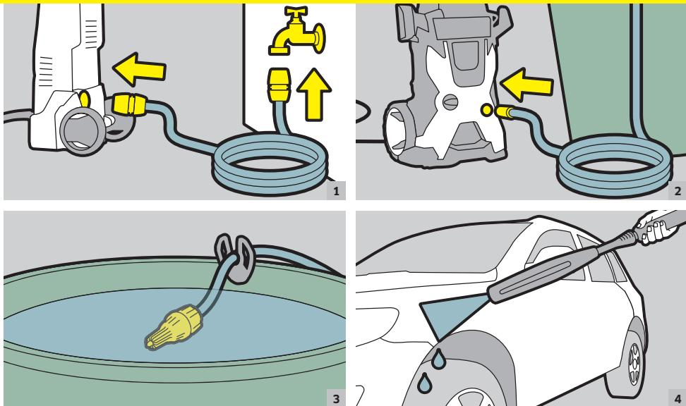
**1** Bei K 2 – K 3-Geräten Gartenschlauch an Wasserhahn und Gerät anschließen
